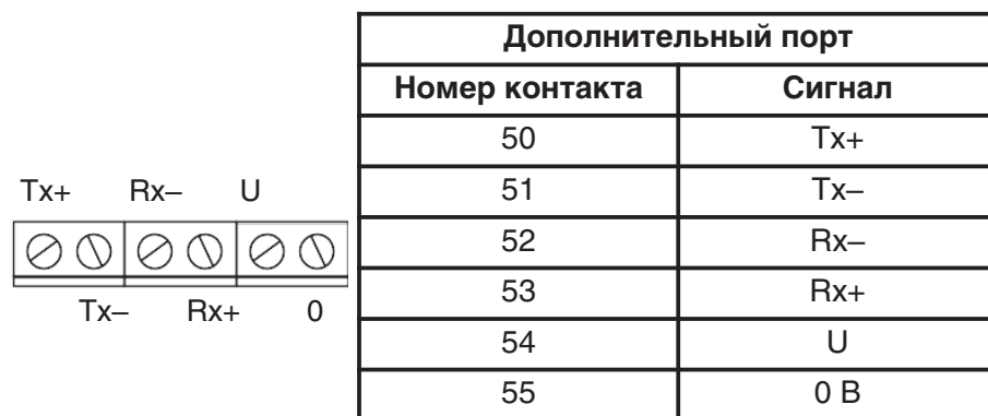
Рисунок 12.17 – Подключение интерфейса RS485 дополнительной платы
