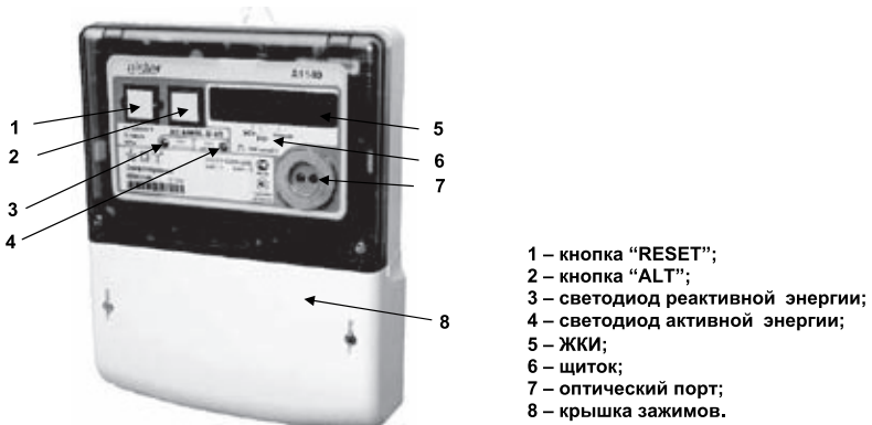
Рисунок 1 - Внешний вид счетчика Альфа А1140
