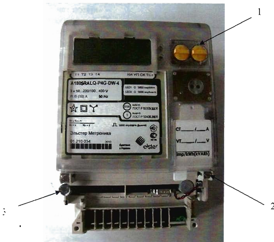
1 - пломба кнопки СБРОС; 2 - пломба поверителя; 3 - пломба ОТК завода-изготовителя
