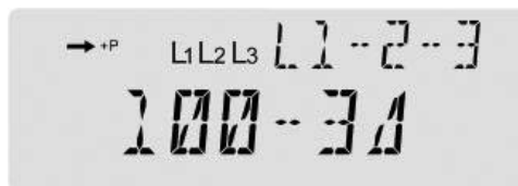
Рисунок 9.4 – Трехпроводная сеть с номинальным напряжением 100 В
