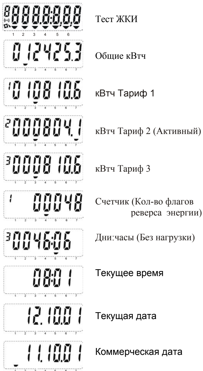
Рис.1-5 Пример отображения некоторых параметров на индикаторе ЖКИ счетчика
