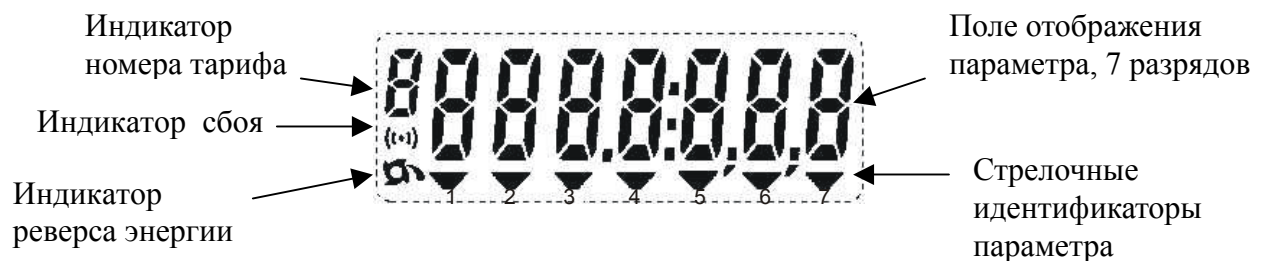
Рис 1-4 Жидкокристаллический индикатор (ЖКИ) счетчиков модификаций А120 и А140
