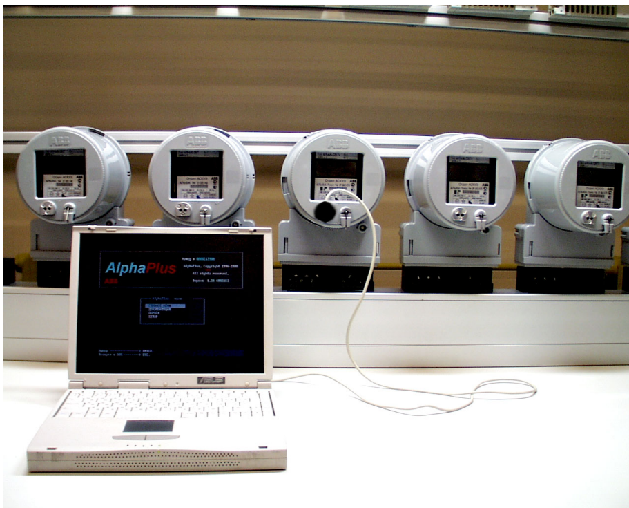
Рис.3 Ориентация преобразователя АЕ1 при работе со счетчиками Альфа
