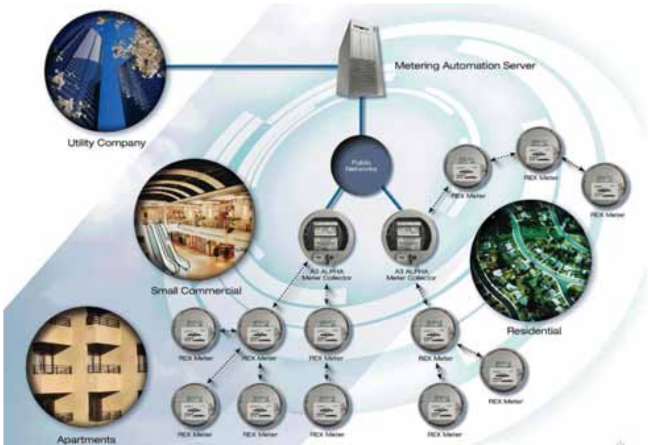
Автоматизированная беспроводная система учета электроэнергии на базе счетчиков АЛЬФА А3 и REX
